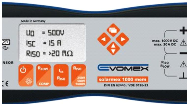
Solarmex 1000 MEM, tester nettilkoblede solceller i henhold til EN 62446. Målingene foretas på DC siden av solceller, som er frakoblet inverteren, f.eks. som kvalitetskontroll før montering eller til feilsøking på eksisterende panelinstallasjon.
