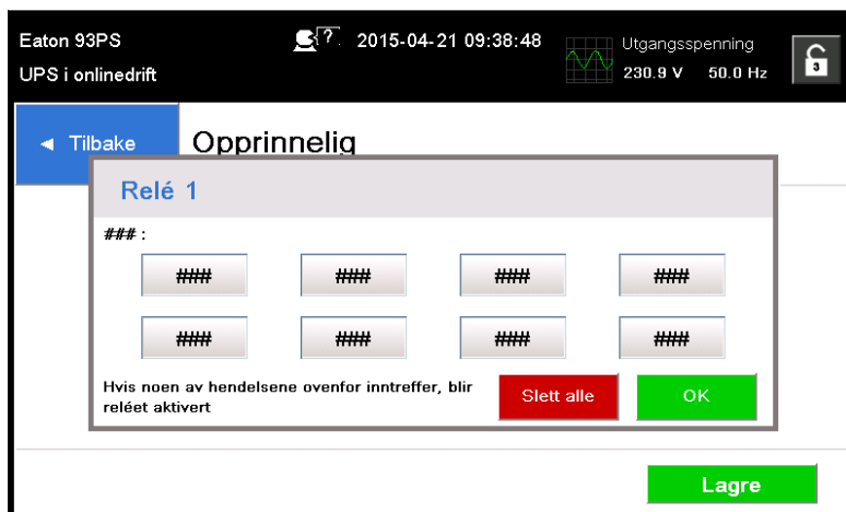
Figur 30. Innlegging av koder for funksjonene som skal utløse reléet
