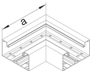
**Flachwinkel aus Grundprofil aus Aluminium zu BRA 70x130mm Oberteil 80mm eloxiert**
