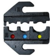
AB I-6. PRESSBAKKE FOR ISOLERTE KABELSKO 0,5- 6MM 2 TIL AB 3 ♥ .||
