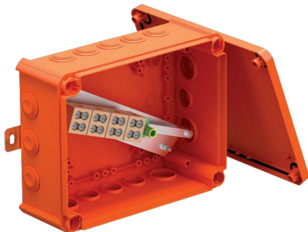
Koblingsboks med keramiske dobbelteklemmer og myke innstikketninger. Tilstrekkelig ledningsrom gjennom diagonalt plassert tilkoblingsenhet med komplett forhåndsmonterte temperaturbestandige keramikklemmer. Grønn-gul merket jordledningsklemme. Feste på godt tilgjengelige ytre stropper. Godkjent for kabelanlegg med elektrisk opprettholdelse av funksjon iht. DIN 4102 del 12, funksjonssikringsklassene E30, E60 og E90.
