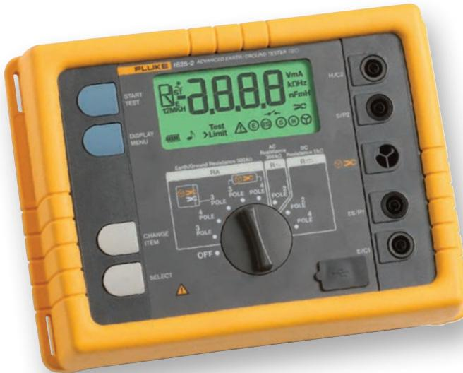
sistans med strømtenger alene. Denne metoden innebefatter at to tenger plasseres rundt jordingsspydet og kobles til testeren. Det er ikke bruk for ekstraspyd. En kjent, fast spenning induseres av den ene tangen, og spenningen måles med den andre. Testeren beregner resistansen i jordingsspydet automatisk.
