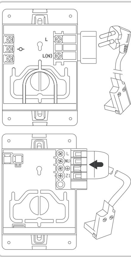
(N) Elektrisk fastmontasje må bare utføres av autorisert installatør! Hvis tilførselsledningen er skadet må den byttes av leverandørens serviceperson, eller tilsvarende kvalifisert person, for å unngå fare.
