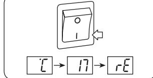
Blinkar det °C – 17 – rE i displayen när man sätter på elementet betyder det att DT har varit utan ström under en längre tid och man bör då genom gå en Start – Reset inställning.
