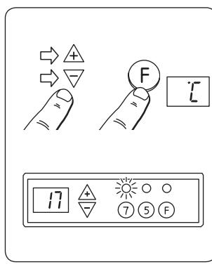
(°C) vilkkuu kolme kertaa ja sen jälkeen 17 (°C) vilkkuu jatkuvasti. Valitse ▲ - tai ▽ -näppäimillä haluamasi säätölämpötila. Vahvista valinta painamalla nopeasti F-näppäintä. Normaalilämpötila jatkuu kolme tuntia ennen kuin säätölämpötila alkaa automaattisesti. (Esim. klo 17.00 alkaa säätölämpötila ja LED-valo (1) alkaa vilkkuva hitaasti.) (Kolmen tunnin ajan säätölämpötilajakson käynnistämisenstä säätölämpötilajakson alkamiseen LED-valo (1) palaa jatkuvasti.)
