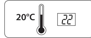
Jos tämänhetkinen huoneen lämpötila ja Neon asetus eivät vastaa toisiaan, Neo-lämmitin on kalibroitava.
