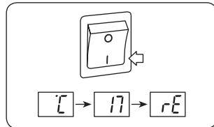
Kun lämmitin käynnistetään, näytössä vilkkuu jakso °C – 17 – rE. Tämä tarkoittaa, että termostaatti on ollut kauan poiskytettyä ja siksi se on käynnistettävä uudestaan.
