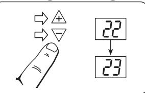
Du kan välja en annan temperatur, antingen i en komfort – eller sänkningsperiod, utan att temperaturen lagras, temperaturen kommer då vara ända tills perioden är slut. (Lagring av temperaturen sker när **F** knappen trycks in i mer än 5 sekunder.)
