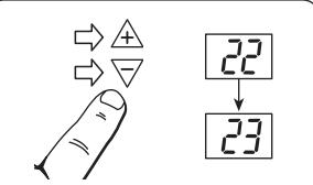
Jos valitset muun lämpötilan joko normaali- tai säästölämpötilajakson aikana tallentamatta kyseistä lämpötilaa painamalla  $\textcircled{F}$ -näppäintä 5 sekunnin ajan, niin lämpötila on voimassa vain kyseisellä jaksolla.
