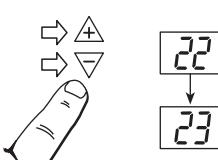
Jos valitset muun lämpötilan joko normaalil- tai säästölämpötilajakson aikana tallentamatta kyseistä lämpötilaa (painamalla F-näppäintä 5 sekunnin ajan), niin uusi lämpötila on voimassa vain kyseisellä jaksolla.
