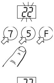
Efter det att perioden med frostsäker temperatur är avslutad kommer komfort temperaturen att blinka i displayen. Genom att trycka på en valfri knapp kommer komfort temperaturen att lysa fast och vara ett permanent val.
