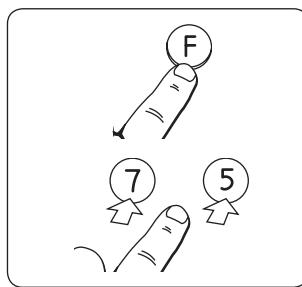
Paina F-näppäintä ja pidä sitä alhaalla ja paina 7 yhden kerran tämänhetkisen aktiivisen jakson tai seuraavan säätölämpötilajakson yliohjaamiseksi. Lampu palaa jatkuvasti kyseisen jakson ajan. Säätölämpötila alkaa uudestaan kuten tavallista seuraavasta jaksosta alkaen.
