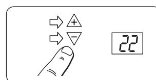
22 (°C) kommer nu blinka i displayen, och du kan nu välja den komfort temperatur du vill att rummet skall ha. När ditt val visas i displayen, tryck då in F i mer än 5 sekunder för att bekräfta ditt val. Görs det inget val kommer 22 (°C) att lagras efter 7 sekunder. Elementet är nu i normal drift och med de funktioner som finns för CA (Stugor)
