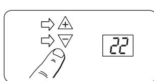
22 (°C) kommer nu blinka i displayen, och du kan nu välja den komfort temperatur du vill att rummet skall ha. När ditt val visas i displayen, tryck och håll in F i mer än 5 sekunder för att bekräfta ditt val. Görs det inget val kommer 22 (°C) att lagras efter 7 sekunder. Elementet är nu i normal drift och med de funktioner som finns för OF (Kontor)
