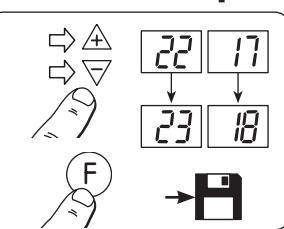
Valitse uusi normaali- tai säästölämpötila normaali- tai säästölämpötilatoiminnon aikana painamalla  $\triangle$ - tai  $\square$ -näppäimiä.
