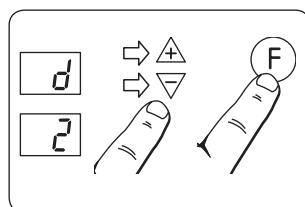
Om du först har tryckt på ⑤ för att ändra inställningarna på dagsänkning, kommer nu d att blinka tre gånger i displayen. Därefter kommer ett tillfälligt tal att visas i displayen. Använd  $\triangle$  eller  $\square$  knappen för att ange rätt veckodag (måndag = 1 osc). Bekräfta genom att trycka på F knappen.
