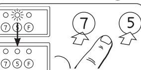
För att radera en sänkningsinställning, tryck och håll in **7** (natt) eller **5** (dag) tills den tillhörande lampan släcks och blir mörk.
