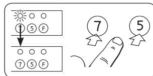
För att radera en sänkningsinställning, tryck och håll in ⑦ tills den tillhörande lampan (4) släcks och blir mörk.
