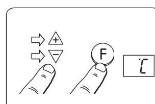
°C kommer blinka tre gånger och därefter kommer 17 (°C) att blinka kontinuerligt. Med **▲** eller **▼** knappen kan man välja den temperatur som skall vara under sänkningsperioden.
