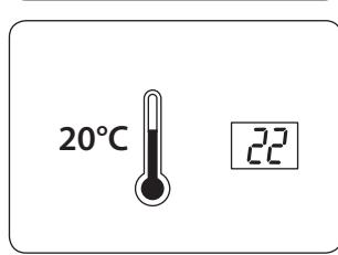
Paina F-näppäintä ja pidä sitä alhaalla ja paina yhden kerran  $\nabla$ -näppäintä (lyhyt painallus). Vapauta F-näppäin.  $^{\circ}\text{C}$  vilkkuu näytössä 3 kertaa ja asetetava lämpötila vilkkuu. Paina  $\Delta$  - tai  $\nabla$ -näppäimiä kunnes termostaatin lämpötila on sama kuin huoneen todellinen, mitattu lämpötila. Tallenna valinta painamalla F-näppäintä 5 sekunnin ajan.
