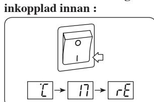
**Blinkar det °C – 17 – rE i displayen** när man sätter på elementet betyder det att DT har varit utan ström under en längre tid och man bör då genom gå en Start – Reset inställning.
