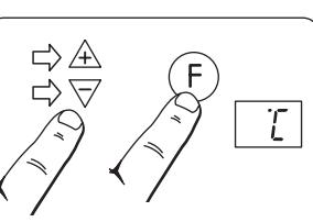
**°C** kommer blinka tre gånger i displayen där efter kommer den tidigare valda temperaturen blinka i displayen. Med **△** eller **▽** knappen kan man välja den temperatur som skall vara under sänkningsperioden. När ditt val visas i displayen, tryck då på **F** (kort tryck) för att bekräfta ditt val
