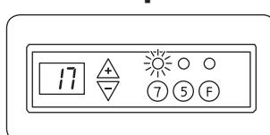
Säätölämpötilajakson aikana LED-valo (1) vilkkuu hitaasti. Jatkuva valo osoittaa, että säätölämpötila ei ole kyseisellä hetkellä aktiivinen, mutta alkaa säädettyyn aikaan illalla.
