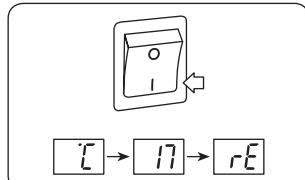
Dersom det blinker °C – 17 – rE i display når ovnen slås på betyr det at DT har vært uten strøm i en lengre tid og må gjennom en Start - Reset prosedyre.
