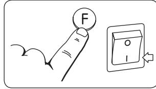
Trykk inn og hold F inne og slå på DT ved hjelp av hovedbryter. Forsett å holde F inne inntil det blinker rE i display. Slipp da opp F knappen.
