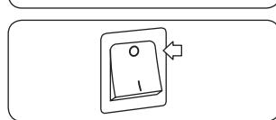
Stäng av DT med hjälp av huvudbrytaren som sitter på sidan bak elementet.
