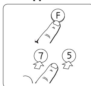
Håll in F och tryck en gång på 7 för att hoppa över den pågående eller kommande sänkningsperioden. Den tillhörande lampan (4) kommer lysa konstant för den aktuella perioden. När den valda perioden är över kommer termostaten automatiskt återgå och sänka efter sitt vanliga program.
