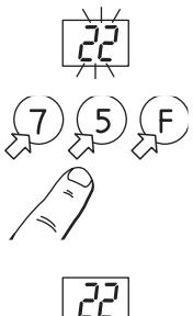
Kun jäätymistä estäävä lämpötilajakso loppuu, näytössä vilkkuu normaalilämpötila. Kun mitä tahansa näppäintä painetaan, normaalilämpötilan osoittimen valo alkaa palaa jatkuvana, mikä osoittaa pysyvää valintaa.
