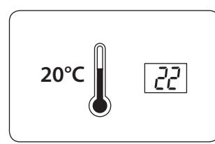
Nyt lämmitin toimii näytön osoittamalla lämpötilalla, ja jonkin ajan kuluttua Neon lämpötila vastaa huoneen todellista lämpötilaa. Tämä menettely voidaan toistaa myöhemmin oikean kalibroinnin varmistamiseksi.
