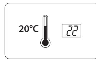
Nyt lämmitin toimii näytön osoittamalla lämpötilalla, ja jonkin ajan kuluttua Neon lämpötila vastaa huoneen todellista lämpötilaa. Tämä menettely voidaan toistaa myöhemmin oikean kalibroinnin varmistamiseksi.
