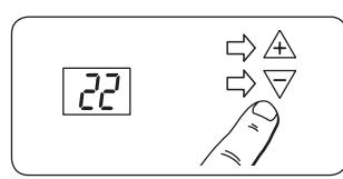
22 (°C) kommer nu blinka i displayen, och du kan nu välja den komfort temperatur du vill att rummet skall ha. När ditt val visas i displayen, tryck då in F i mer än 5 sekunder för att bekräfta ditt val. Görs det inget val kommer 22 (°C) att lagras efter 7 sekunder. Elementet är nu i normal drift och med de funktionerna som finns för CA (Stugor)
