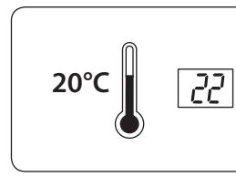
Nu kommer DT igen visa önskad temperatur och efter en tid kommer detta matcha med den verkliga temperaturen som är mätt. Det kan hänta att en kalibrering får upprepas för att uppnå en full matchning mellan önskad och verlig temperatur.
