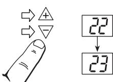
Du kan välja en annan temperatur, antingen i en komfort – eller sänkningsperiod, utan att temperaturen lagras, temperaturen kommer då vara ända tills perioden är slut. (Lagring av temperaturen sker när F knappen trycks in i mer än 5 sekunder.)
