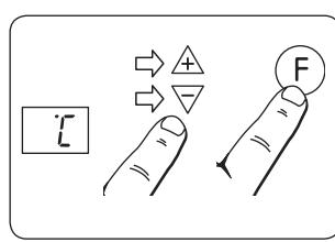
$^{\circ}\text{C}$  kommer blinka tre gånger i displayen där efter kommer den tidigare valda temperaturen blinka i displayen. Med  $\triangle$  eller  $\square$  knappen kan man välja den temperatur som skall vara under sänkningsperioden. När ditt val visas i displayen, tryck då på F (kort tryck) för att bekräfta ditt val
