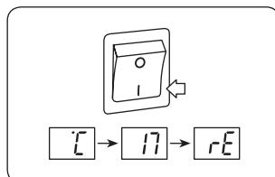
Blinkar det °C – 17 – rE i displayen när man sätter på elementet betyder det att DT har varit utan ström under en längre tid och man bör då genom gå en Start – Reset inställning.
