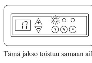
Vihreä lamppu (4) vilkkuu hitaasti näytössä ja osoittaa, että säästölämpötila on valittu ja aktivoitu.
