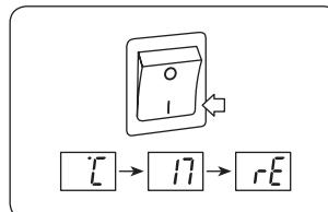
Jos näytössä vilkkuu °C – 17 – rE, kun lämmitin kytketään päälle, se merkitsee, että NEO-lämmitin on ollut pois käytöstä pitkään ja se on Käynnistettävä uudestaan – Asetukset on tehtävä uudestaan.
