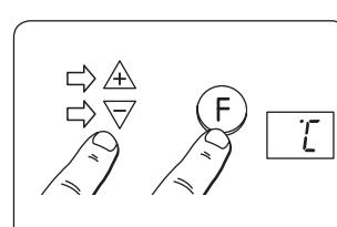
°C kommer blinka tre gånger och därefter kommer 17 (°C) att blinka kontinuerligt. Med **▲** eller **▼** knappen kan man välja den temperatur som skall vara under sänkningsperioden. När ditt val visas i displayen, tryck då på **F** (kort tryck) för att bekräfta ditt val.
