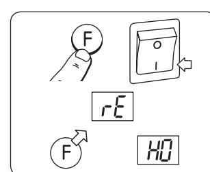
Paina F-näppäintä ja pidä sitä alhaalla ja kytke sen jälkeen lämmitin pääälle (ON).
