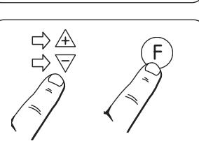
Om du först har tryckt på **5** för att ändra inställningarna på dagsänkning, kommer nu **d** att blinka tre gånger i displayen. Därefter kommer ett tillfälligt tal att visas i displayen. Använd **△** eller **▽** knappen för att ange rätt veckodag (måndag = 1 osc). Bekräfta genom att trycka på **F** knappen.
