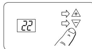
22 ( $^{\circ}\text{C}$ ) kommer nu blinka i displayen, och du kan nu välja den komfort temperatur du vill att rummet skall ha. När ditt val visas i displayen, tryck då in F i mer än 5 sekunder för att bekräfta ditt val. Görs det inget val kommer 22 ( $^{\circ}\text{C}$ ) att lagras efter 7 sekunder. Elementet är nu i normal drift och med de funktionerna som finns för OF (Kontor).
