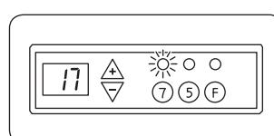
I perioder med aktiv sänkning kommer LED (4) blinka långsamt. Där LED (4) lyser fast betyder det att sänkningen förnärvarande inte är aktiva, men att den kommer starta på planlagd tidpunkt på kvällen.
