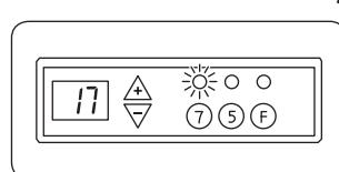
I perioder med aktiv senking vil LED (4) blinke langsomt. Dersom LED (4) lyser fast betyr det at senking for tiden ikke er aktiv, men vil starte på det planlagte tidspunkt på kvelden.
