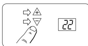
22 (°C) kommer nu blinka i displayen, och du kan nu välja den komfort temperatur du vill att rummet skall ha. När ditt val visas i displayen, tryck då in F i mer än 5 sekunder för att bekräfta ditt val. Görs det inget val kommer 22 (°C) att lagras efter 7 sekunder. Elementet är nu i normal drift och med de funktioner som finns för OF (Kontor)
