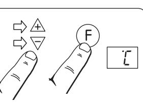
**°C** vil blinke tre ganger i display og den tidligere valgte senketemperatur vil blinke i display. Med **▲** eller **▼** knappene kan det velges den temperatur som skal være under senkeperioden. Når ditt valg vises i display, trykk **F** (kort trykk) for å bekrefte ditt valg.
