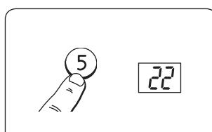
Paina 5 yli 5 sekunnin ajan. Säädetty normaalilämpötila näkyy näytössä. Näppäimen 5 yläpuolella oleva LED-valo palaa jatkuvasti, mutta näppäimen 7 yläpuolella oleva LED-valo jatkaa vilkumista. Nyt laitteessa on väliaikainen normaalilämpötilajakso, joka kestää 5 tuntia.
