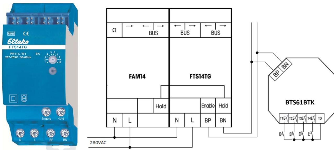
2 tråds BUS interface for tilkobling av BTS61BTK (enhet med tilkobling for 4 stk brytere).
