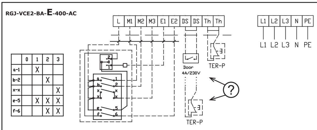
\* **Det anbefalte minste tverrsnittet på kabelen for tilkobling av betjeningspanelet er 6x0.5mm<sup>2</sup>.**
