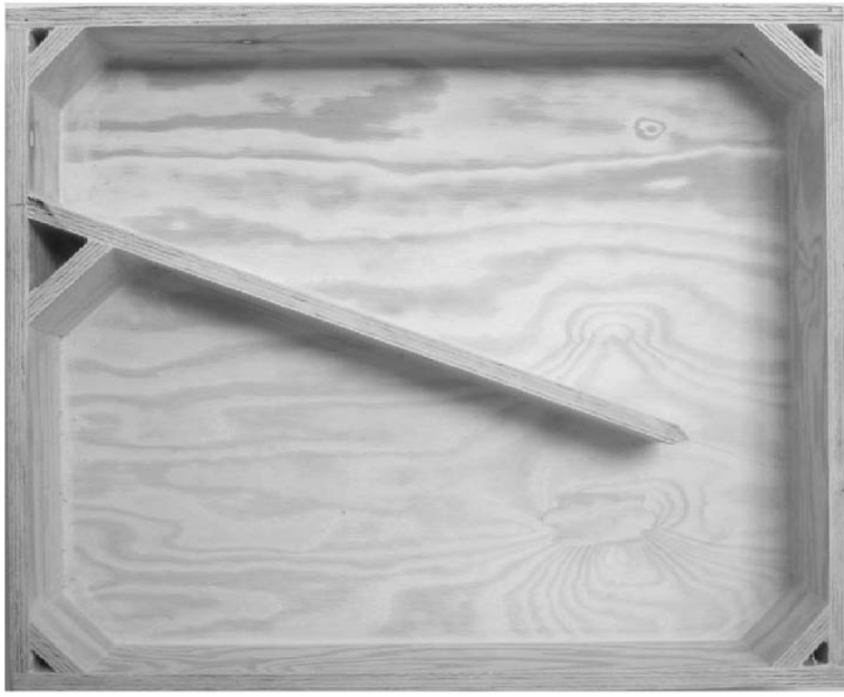
Innsiden på ferdige veggbokser med transmisjonslinje prinsipp.
