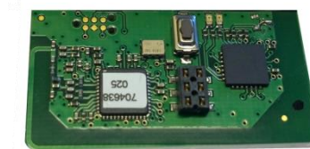
Bilde av radiosender til RM-2 (monteres inn i komfyrsensor)
