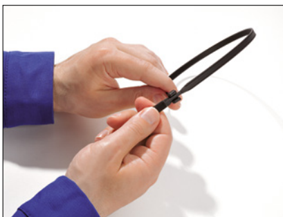
1. legg den tynne delen av båndet i det åpne låsehodet.
