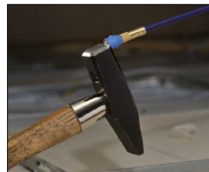
Magneten kan løfte metalleder med vekt opp til 2,5 kg.
