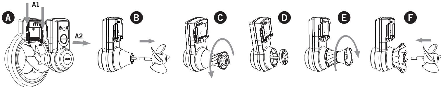
Lyft motorenheten ur ramstycket (se fig A) genom att först skjuta de båda låsknapparna mot centrum (A1). Tag därefter loss motorenheten (A2).
