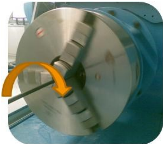
Fig: Torsion cycles: 50N ± 135° 100°/s
