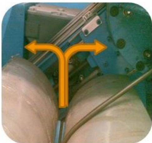
Fig: Reverse bending: 100N ± 45° 160°/s
