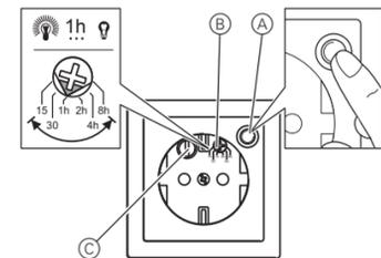
Med et nytt trykk på knappen kan du også koble ut timeruttaket før tiden er utløpt.
