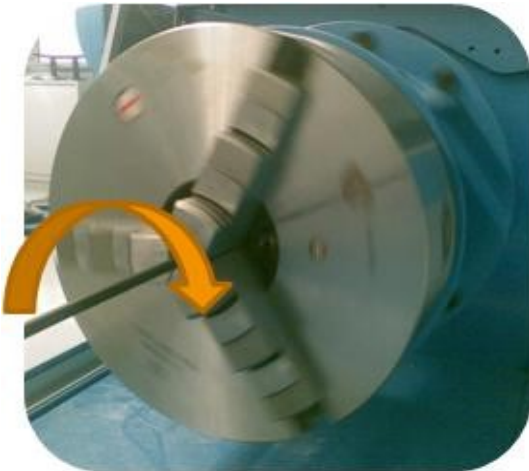
Fig: Torsion cycles: 50N \pm 135^\circ 100^\circ/s
