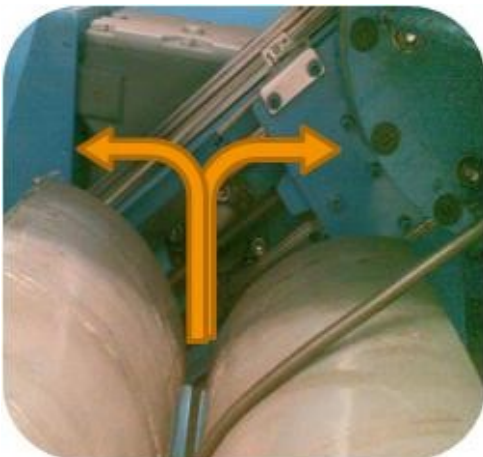
Fig: Reverse bending: 100N \pm 45^\circ 160^\circ/s
