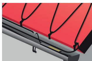
7. Instalați senzorii și prelungiți cablurile senzorilor, cablurile reci/cablurile de terminații și așezați conexiunile în locuri uscate. Etanșați toate orificiile de pătrundere, cum ar fi prin acoperișuri și pereti.
