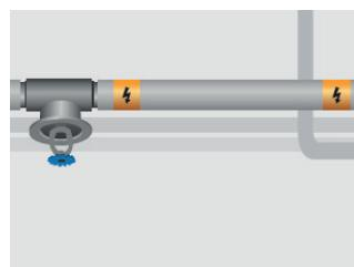
9. Efter isolering ska märktejp placeras på isoleringen eller rörränorna var 5-6 meter. Vid installation under mark ska täckband med varningsskylt läggas 10 cm över kablarna.
