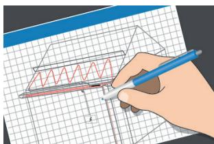
2. Nubraižykite kabelių, jutiklių, termostato, kabelių jungčių, maitinimo tiekimo, kabelių tiesimo ir komutatoriaus vietas planą.
