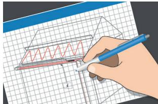
2. Entwerfen Sie einen Positionsplan für Kabel, Fühler und Thermostate, Kabelanschlüsse/Kaltleiter, Anschlussdose, Kabelwege und Schalttafel.
