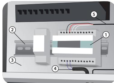
1 - Säädin; 2 - DIN-kisko; 3 - Sähkökaappi; 4 - Liitoskaapeliliitintä; 5 - Anturiliitintä
