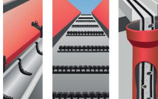
5. Nainstalujte spojovací krabici a upevňovací příslušenství do žlabů, úžlabí žlabů, na střechu nebo kabel.
