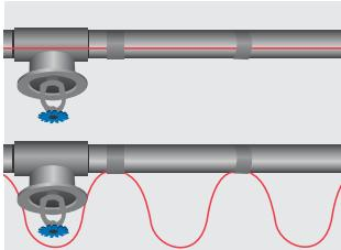
5. Sirgkaablid ja andur tuleb paigaldada joonisel 2 kujutatud viisil. Keerdkaablid kinnitatakse joonisel kujutatud viisil torul iga u. 1 m järel alumiiniumteibiga.
