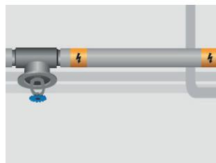
9. После установки теплоизоляции наклейте защитную маркировочную ленту на изолационную оболочку или траншею для труб через каждые 5 м. При установке на поверхность необходимо уложить защитную ленту с предупреждающим знаком на 10 см выше кабелей.
