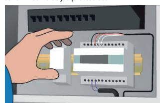
9. Instalējiet termostatu/regulatoru un savienojet kabeļus ar savienotājkārbām un sadales dēli.
