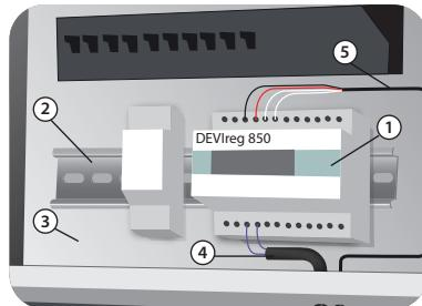
1 - Regulator; 2 - DIN-skinne; 3 - Elskab; 4 - Kold ledningstilslutning; 5 - Følertilslutning
