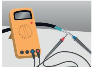
3. Provjerite otpor izolacije grijajućih kabela. Izmjerena vrijednost ne smije biti manja od  $50\text{ M}\Omega$ .
