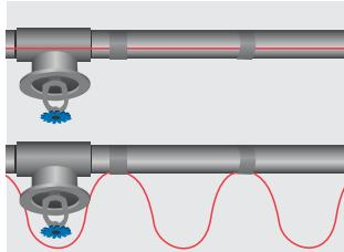
5. Düz hatlar ve sensör Şekil 2'de gösterildiği gibi takılmalıdır. Bükülmüş hatlar alüminyum bantla yaklaşık her 1 m'lik boru için gösterildiği gibi takılır.
