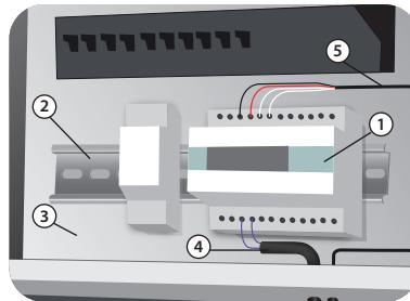
1 - Regulator, 2 - DIN-skinn,; 3 - Siktningsskap, 4 - Tilkobling av tilledning, 5 - Sensortilkobling
