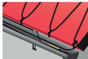
7. Zainstalować czujniki i przedłużyć przewody czujników, przewody zasilające oraz umieścić połączenia w suchym miejscu. Uszczelnić wszystkie przejścia, np. przez dachy i ściany.
