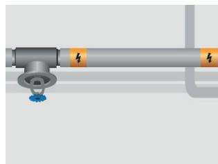
9. Wickeln Sie nach der Isolierung im Abstand von 5 m Sicherheitsmarkierungsband um die Isolierschale oder die Rohrgräben. In unterirdischen Installationen muss 10 cm über den Leitungen Abdeckband mit einem Warnschild verlegt werden.
