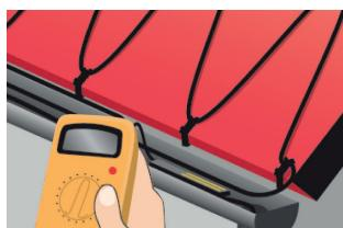
8. Kontroller og sammenlign isolasjonsmotstanden på nytt. Målt verdi må være minimum 50 MΩ.
