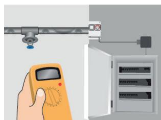
8. 重新检查绝缘阻值。将电缆连接至接线盒和配电盘。
