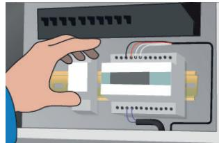
9. 安装温控器/控制器，然后将电缆连接至接线盒和配电盘。
