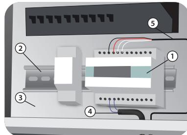
1 — контроллер; 2 — DIN-рейка; 3 — электрический шкаф; 4 — подключение холодного проводника; 5 — подключение датчика
