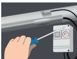
7. Bevestig de sensor en de sonde daarvan boven op de leiding en dek deze af met aluminium tape. Verleng uitlopers/draden en houd aansluitingen droog. Montere de aansluitdoos op de leiding of in de buurt ervan en installeer de thermostaat op de leiding of in de buurt ervan (afhankelijk van de thermostaat).
