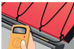
8. Znovu zkontrolujte a porovnejte izolační odpor. Naměřená hodnota nesmí být nižší než  $50\text{ M}\Omega$ .
