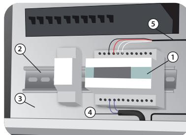
1 – szabályozó; 2 – DIN-sín; 3 – elektromos szekrény; 4 – hidegvezető csatlakozása; 5 – érzékelőcsatlakozás
