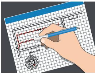
2. Tegn opp en plan over plassering av kabel/kabler, sensorer og termostat, kabeltilkoblinger, kaldende, tilkoblingsboks, kabelbaner og brytertavle.
