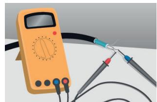
3. Zkontrolujte izolační odpor topných kabelů. Naměřená hodnota nesmí být nižší než  $50\text{ M}\Omega$ .
