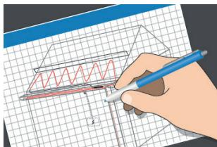
2. Розробіть план розміщення кабелів, датчиків, терморегуляторів, кабельних з'єднань / холодних кінців, з'єднувальної коробки, кабельних трас і комутаційної панелі.
