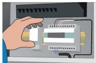
9. Установіть терморегулятор/контролер і підключіть кабелі до з'єднувальних коробок і до комутаційної панелі.
