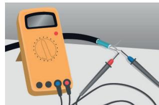
3. Kontrollér varmekablernes isolationsmodstand. Den målte værdi skal være mindst 50 MΩ.
