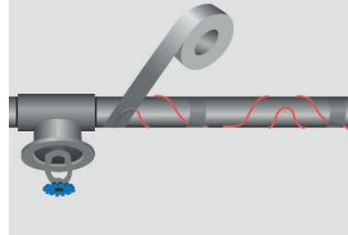
6. Bringen Sie Aluminiumband unterhalb (bei Kunststoffrohren unverzichtbar) und oberhalb der gesamten Länge der Leitung an. Stellen Sie sicher, dass die Leitungen nicht über scharfe Kanten verlaufen.
