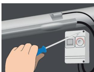
7. Fixez et couvrez la sonde et l'extrémité sur la partie supérieure du tube avec du ruban en aluminium. Étendez les liaisons froides et gardez les raccordements au sec. Montez le boîtier de raccordement sur le tube ou à proximité et installez le thermostat sur le tube ou à proximité (selon le thermostat).
