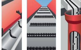
5. Installeer de aansluitdoos en bevestigingsmiddelen in de goten, kilgoten, op het dak en/ of de kabel.
