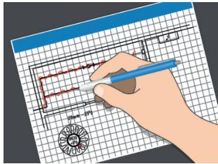
2. 绘制平面图，确定电缆、传感器和温控器、电缆接头、冷接线、接线盒、电缆路径和配电盘的位置。
