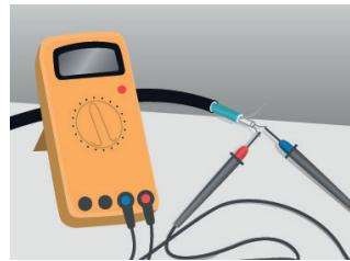
3. Vérifiez la résistance d'isolation des câbles chauffants. La valeur mesurée ne doit pas être inférieure à  $50\text{ M}\Omega$ .
