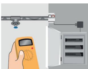
8. Révérifiez la résistance d'isolation. Raccordez les câbles aux boîtiers de raccordement et au tableau de distribution.
