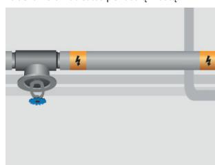
9. Suotavę priklijuokite saugos markiravimo juostą ant izoliacijos korpuso ar vamzdžio kanalo kas 5 m. Jeigu montuojama po pagrindinį, virš kabelių kas 10 cm būtina naudoti dengiamają juostą su išpejamoju ženklu.
