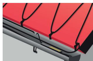
7. Monteer sensoren en verleng sensorkabels en uitlopers/sluit kabels af en maak aansluitingen op een droge locatie. Dicht alle doorvoeringen, bv. door daken en muren af.
