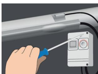
7. Fest og dekk til sensoren og tuppen på oversiden av røret med aluminiumstape. Forleng kaldender/tilledninger og hold koblingene tørr. Monter koblingsboksen på eller nær røret, og installer termostaten på eller nær røret (avhengig av termostaten).
