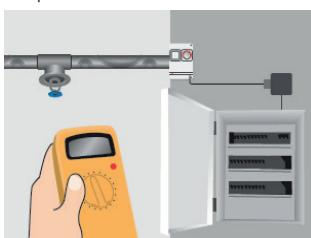
8. Tarkista eristysvastus uudelleen. Kytke kaapeli kytkentärasioihin ja sähkökeskuseen.
