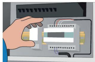
9. Zamontować termostat/sterownik i podłączyć kable do puszek połączeniowych i tablicy rozdzielczej.
