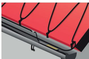
7. Installera givare och förläng givarkablar, kallkablarna/kabelanslutningar och placera anslutningarna på en torr plats. Täta alla hål som tagits upp i t.ex. vägg och tak.
