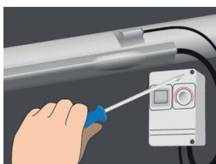
7. Zamocować czujnik na rurze i przykleić go za pomocą taśmy aluminiowej. Przedłużyc przewody zasilające i upewnić się że połączenia będą suche. Skrzynkę rozdzielczą należy zamontować na rurze lub w jej pobliżu, a termostat zainstalować na rurze lub w jej pobliżu (w zależności od modelu termostatu).
