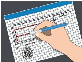
2. Piirrä suunnitelma kaepeli(e)n, anturien ja termostaatin sekä kaapelikytköiden, liitosjohtojen, kytkentärasian, kaapelipolkujen ja sähkökeskuksen sijoittamisesta.
