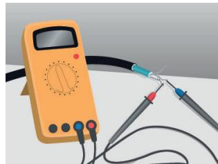
3. Kontroller isolasjonsmotstanden til varmekabler. Målt verdi må være minimum 50 MΩ.
