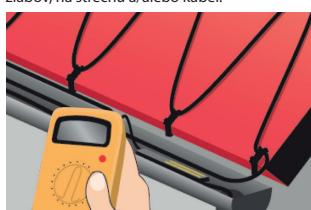
7. Nainštalujte snímače a predĺžovacie káble snímač, studené koncovky/ukončovacie káble a položte pripojenia na suché miesto. Utesnite všetky prieходy, napr. cez strechy a steny.
