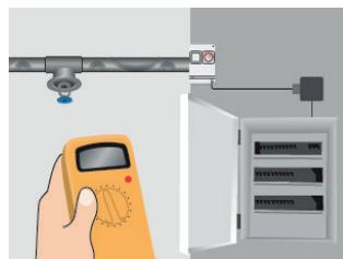
8. Prüfen Sie den Isolationswiderstand erneut. Verbinden Sie die Leitungen mit den Anschlussdosen und der Schalttafel.
