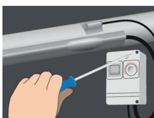
7. Kinnitage ja katke andur ning toru peal olev ots alumiiniumteibiga. Piikendage toitejuhtmed ja hoidikke ühendused kuivad. Paigaldage ühenduskarp torule või selle läheodusse ja paigaldage termostaat torule või selle läheodusse (olenevalt termostaadist).
