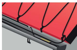
7. Instalējiet sensorus un pagariniet sensoru kabeļu, atdzesētos galus/kabeļu nobeigumus. Savienojumiem jābūt sausumā. Noblivejiet visas izveidotās atveres jumtā un sienās.
