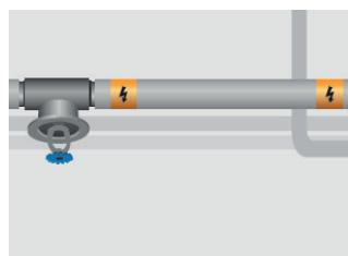
9. Po zaizolování nalepte na izolační pláště nebo kabelové vedení po každých 5 m bezpečnostní pásku. U podpovrchových instalací musí být 10 cm nad kably umístěna krycí páska s výstražnou značkou.
