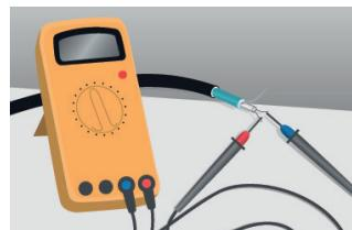
3. Sprawiżdzić oporność izolacji kabli grzejnych. Zmierzona wartość nie może być mniejsza niż 50 MΩ.
