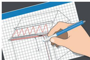
2. Razvijte plan postavljanja za kable, osjetnike i termostate, spojeve kabela / hladne krajeve, spojnu kutiju, putanje kabela i razvodnu ploču.
