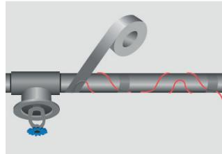
6. Aplique cinta de aluminio debajo (obligatorio para tuberías de plástico) y encima de toda la longitud del cable. Asegúrese de que los cables no crucen bordes afilados.
