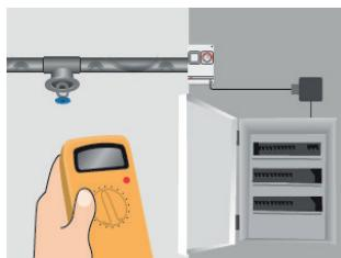
8. Повторно проверьте сопротивление изоляции. Подключите кабели к соединительным коробкам и к распределительному щиту.
