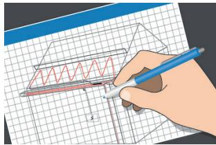
2. 制作电缆、传感器和温控器、电缆连接/冷接线、接线盒、电缆路径和配电盘的平面图。
