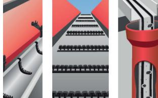
5. Priključno omarico in pribor za pritrjevanje vgradite v žlebove, odprtine za žlebove, streho in/ali kabel.
