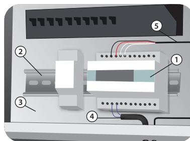
1 – regulátor; 2 – lišta DIN; 3 – elektrický rozvaděč; 4 – pripojení studeného vedení; 5 – pripojení čidla
