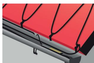
7. Montieren Sie die Fühler und verlängern Sie die Führerkabel, die Kaltleiter/versichern Sie die Kabel mit Klemmen und legen Sie die Anschlüsse trocken. Dichten Sie alle Durchführungen ab, z. B. durch Dächer und Wände.
