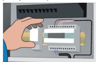
9. Nainstalujte termostat/regulátor a připojte kabely ke spojovacím krabicím a do rozvaděče.
