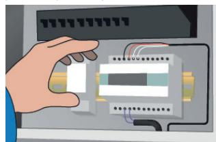
9. Instalirajte termostat/regulator i spojite kable na spojne kutije i razvodnu ploču.
