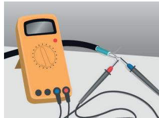
3. Verifique a resistência de isolamento dos cabos de aquecimento. O valor medido não deverá ser inferior a 50 MΩ.
