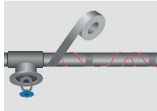
6. Bruk aluminiumstape under (obligatorisk for plastrør) og over hele kabellengden. Pass på at kablene ikke krysser skarpe kanter.
