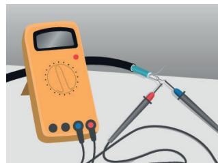
3. Verificați rezistența izolației cablurilor de încălzire. Valoarea măsurată nu va fi mai mică de 50 MΩ.
