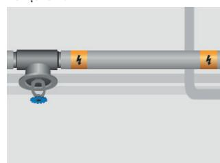
9. Po wykonaniu izolacji termicznej, co 5 m umieścić taśmę ostrzegawczą na osłonie izolacyjnej. W instalacjach podpowierzchniowych taśmę maskującą ze znakiem ostrzegawczym należy umieścić 10 cm nad kablami.
