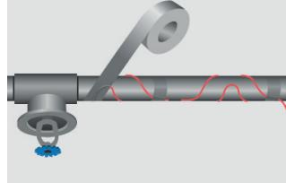
5. Rovné vedení a čidlo musí být instalovány tak, jak je znázorněno na obr. 2. Zkroutené vedení se připevní využitím výobrazeným způsobem přiblížené po každém 1 metru trubky pomocí hliníkové pásky.
