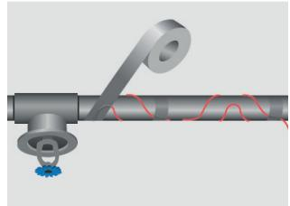
6. Postavite aluminijsku traku ispod (obvezno za plastične cijevi) i iznad cijelom duljinom kabela. Provjerite da kabeli ne prelaze preko oštredih rubova.
