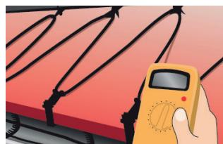
6. Postavite kabel(e) na krov, u oluke i odvode oborinskih voda. Ponovno provjerite i usporedite otpor izolacije.
