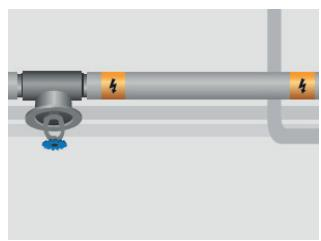
9. Після розташування ізоляції наліпіть стрічку з попереджуvalним маркуванням на ізоляційну оболонку або траншеї для труб через кожні 5 м. У разі прокладання кабелів під поверхнею захисна стрічка з попереджуvalним знаком має бути прокладена над кабелями на висоті 10 см.
