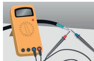
3. Проверьте сопротивление изоляции нагревательных кабелей. Измеренное значение должно быть не менее 50 МОм.
