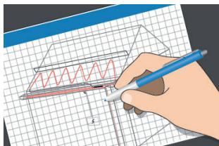
2. Készítsen elrendezési tervet, feltüntesse az összes káblelt, érzékelőt és termosztátot, kábelcsatlakozást/hidegvéget, csatlakozódobozt, kábelútvonalat és kapcsolótáblát.
