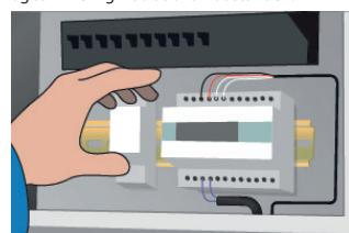
7. Installer følere, og forlæng følerkabler, koldkabler/afslutningskabler, og anbring tilslutningsgerne på et tørt sted. Tætn alle gennemgange i f.eks. tage og vægge.
