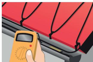
8. Ponovno provjerite i usporedite otpor izolacije. Izmjerena vrijednost ne smije biti manja od  $50\text{ M}\Omega$ .
