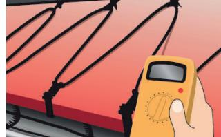
6. Nainštalujte kábel na strechu, do odkvapov a zvodov. Znovu skontrolujte a porovnajte izolačný odpor.
