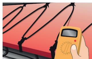
6. Montați cablurile pe acoperiș, în jgheaburi și burlane. Verificați din nou și comparați rezistența izolației.
