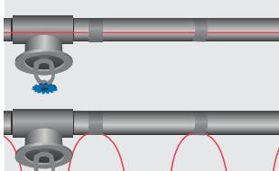
5. Les lignes droites et sonde doivent être installés comme indiqué à la Fig. 2. Les lignes torsadées sont fixées comme indiqué pour chaque tube d'environ 1 m avec du ruban en aluminium.
