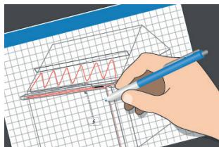
2. Vytvořte si plán uspořádání kabelů, čidla a termostatu, a rozmištění spojení kabelů, studeného vedení, spojovací krabice, vedení kabelů a rozvaděče.
