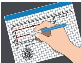
2. Uzzīmējiet plānu ar kabeļu, sensoru termostata, kabeļu savienojumu, atdzesētā gala, savienotājkārbas, kabeļu kanālu un sadales dēļa novietojumu.
