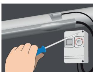
7. Sensörü ve borunun üstündeki ucu alüminyum bant tutturun ve kapatın. Soğuk kuyrukları/uçları uzatın ve bağlantıları kuru tutun. Bañlantı kutusunu borunun üzerine veya yakınına monte edin ve termostati borunun üzerine veya yakınına takın (termostata bağlı olarak).
