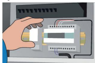
9. Telepítse a termosztátot/szabályozót, és csatlakoztassa a kábeleket a csatlakozódobozokhoz és a kapcsolótáblához.
