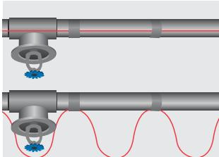
5. Rette linjer og sensor må monteres som vist i Fig. 2. Kabler som skal vikles rundt røret festes som vist med aluminiumstape for hver meter rør.
