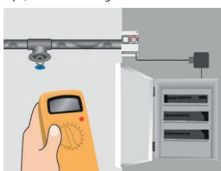
8. Controleer de isolatieweerstand opnieuw. Sluit de kabels aan op de aansluitdozen en op het schakelpaneel.
