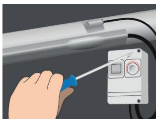
7. Прикріпіть і обклійте датчик і наконечник на верхній труби алюмінієвою стрічкою. Розіграйте холодні кінці/виводи і перевірьте, що з'єднання сухі. Установіть з'єднувальну коробку на трубі або біля неї та встановіть терморегулятор на трубі або біля неї (залежить від терморегулятора).
