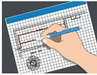
2. Начертайте план за позициониране на кабелите, сензорите и терморегулатора, кабелните съединения, студения край, разклонителна кутия, кабелните канали и електроразпределителното табло.
