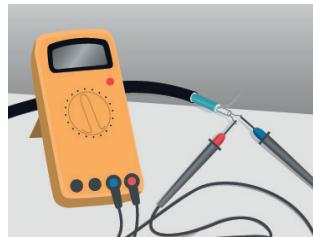
3. Preverite izolacijsko upornost grelnih kablov. Izmerjena vrednost ne sme biti nižja od 50 MΩ.
