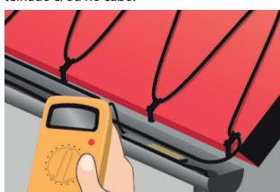
8. Verifique novamente e compare a resistência de isolamento. O valor medido não deverá ser inferior a  $50\text{ M}\Omega$ .
