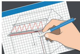
2. Udarbejd planen for anlæggelse af kablet eller kablerne, følere og termostater, kabelsamlinger/koldkabler, tilslutningsboks, kabelføringer og en eltavle.
