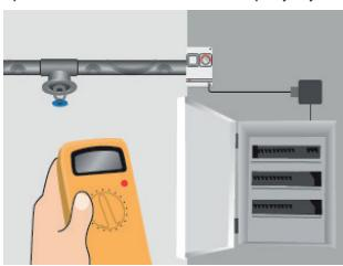
8. Ще раз перевірте опір ізоляції. Підключіть кабелі до з'єднувальних коробок і комутаційної панелі.
