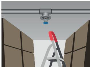
1. Controleer het leidingsysteem dat moet worden verwarmd en zorg dat de leidingen droog, glad en lekvrij zijn. Controleer het schakelpaneel en bereid het voor.
