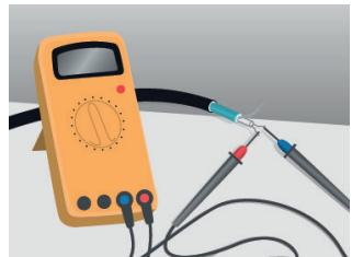
3. Перевірте опір ізоляції нагрівальних кабелів. Вимірює значення мас бути не меншим за 50 МΩ.
