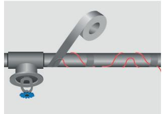
6. Paigaldage alumiiniumteip kogu kaablipikkuse ulatases nii alla (plasttorude korral kohustuslik) kui ka peale. Veenduge, et kaablid ei ületaks teravaid servi.
