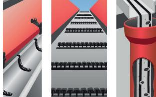
5. 在檐沟、斜沟槽中、屋顶和/或电缆上安装接线盒和固定附件。
