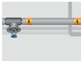
9. Após o isolamento, coloque uma fita de marcação de segurança na cobertura de isolamento ou nas valas dos tubos, a cada 5 m. Nas instalações subterrâneas, deve ser colocada uma fita de cobertura com um sinal de aviso 10 cm acima dos cabos.
