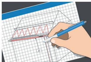
2. Maak een ontwerp tekening voor de kabel(s), de sensoren en thermostaten, de kabelaansluitingen/uitlopers, de aansluitdoos, de kabelpaden en een schakelpaneel.
