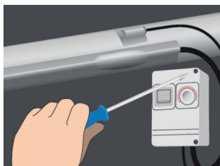
7. Прикрепете и покрайте сензора и върха върху тръбата с алюминиева лента. Удължете студените краища/проводници и поддържайте съединенията сухи. Монтирайте разклонителната кутия върху тръбата или близо до нея и монтирайте терморегулатора на тръбата или в близост до нея (в зависимост от терморегулатора).
