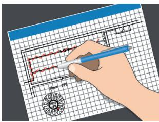
2. Nubraižykite kabelių, jutiklių, termostato, kabelių jungčių, maitinimo tiekimo, kabelių tiesimo ir komutatoriaus vietas planą.
