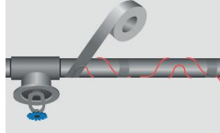
6. Aplique fita de alumínio por baixo (obrigatório para tubos de plástico) e por cima ao longo do comprimento do cabo. Certifique-se de que os cabos não cruzam sobre arestas afiadas.
