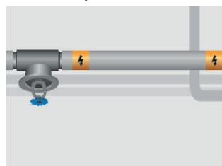
7. Erősítse az érzékelőt és a hegyet a cső felső részére, és fedje le őket alumíniumszalaggal. Hosszabbítás meg a hidegvezégeket/vezetőket, ügyelve arra, hogy a csatlakozások szárazak maradjanak. Szerej fel a csatlakozódobozba a csőre vagy annak közelébe, és telepítse a termosztátot a csőre vagy annak közelébe (a termosztattól függően).
