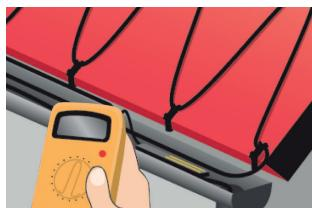
8. Ponownie sprawdzić i porównać oporność izolacji. Zmierzona wartość nie może być mniejsza niż 50 MΩ.
