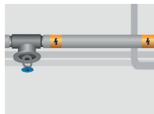
9. 绝缘后，在绝缘夹套或电缆沟上每 5 米贴一个安全警示带。在地下设施中，必须在电缆上方 10 厘米处铺设带有警告标志的覆盖带。
