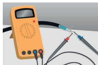
3. Verificați rezistența izolației cablurilor de încălzire. Valoarea măsurată nu va fi mai mică de 50 MΩ.
