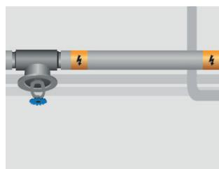
9. Po izolaciji namestite varnostni označevalni trak na izolacijski plošči ali cerne jarke na vsakih 5 m. Pri podzemnih inštalacijah je treba 10 cm nad kabli položiti pokriveni trak z opozorilnim znakom.
