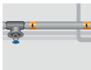
9. Pēc izolēšanas ik pēc 5 m piešķiriniet drošības markējuma lenti uz izolācijas apvalka vai cauruļu tranšejas. Pažemes instalācijas gadījumā 10 cm virs kabeļiem ir jāiekļāj noseglenta ar brīdinājuma zīmi.
