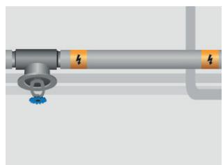
9. Nakon izolacije postavite sigurnosnu označnu traku na izolacijsku plastičnu površinu, pokrovnu traku sa znakom upozorenja mora biti postavljena 10 cm iznad kabela.
