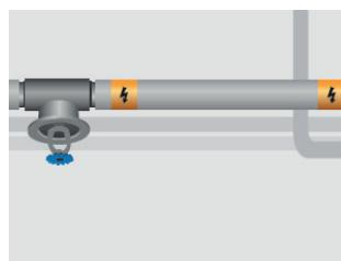
9. Laita eristyksen jälkeen turvamerkin-nät viiden metrin välein eristevaippaan tai putkikouruun. Maan alle asennettaessa on laittettava peite nauha ja varoitusmerkki 10 cm kaapeleiden yläpuolelle.
