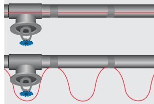
5. Gerade Leitungen und Fühler müssen wie in Abb. 2 gezeigt montiert werden. Verdrehte Leitungen werden wie abgebildet für jedes ca. 1 m lange Rohr mit Aluminiumband befestigt.
