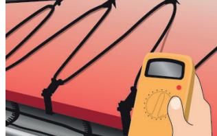
6. Telepítse a kábel(eket) a tetőre, az ereszcsornákba és a lefolyócsövekbe. Végezzen újabb ellenőrzést, és hasonlítsa össze a szigetelési ellenállás értékeit.
