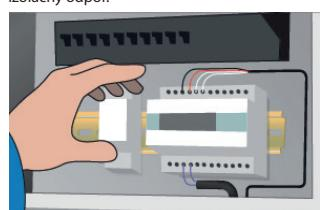
9. Nainštalujte termostat/regulátor a pripojte káble k rozvodným skriňam a k rozvádzaciu.
