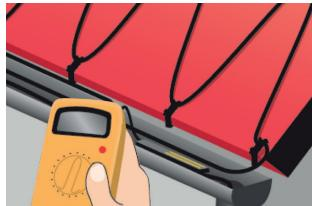
8. 再次检查并比较绝缘阻值。测得的值应不小于 50 MΩ。
