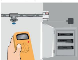
8. Ponovo provjerite otpor izolacije. Spojite kabele sa spojnim kutijama i razvodnom pločom.
