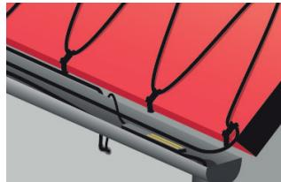
7. 安装传感器并延长传感器电缆、冷接线/端接电缆，然后将接头置于干燥处。密封屋顶和墙壁等上面的所有穿透处。
