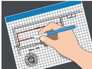
2. Teken een schema voor het plaatsen van de kabel(s), de sensoren en de thermostaat, de kabelaansluitingen, de uitloper, de aansluitdoos, de kabelpaden en de bedieningspost.
