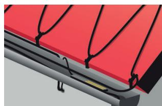
7. Nainstalujte čidla, prodlužte kabely čidel, koncovky studeného vedení/zakončení kabelů a umístěte konektory do sucha. Těsnění veškeré průniky, např. střechami a stěnami.
