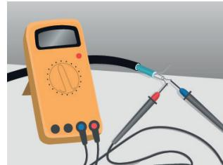
3. 检查加热电缆的绝缘阻值。测得的值应不小于  $50\text{ M}\Omega$ 。
