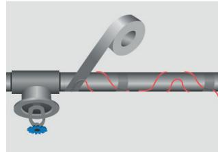
6. Fäst aluminiumtejp under (obligatoriskt för plaströr) och ovanpå röret utmed hela kabelns längd. Se till att kablarna inte korsar vassa kanter.
