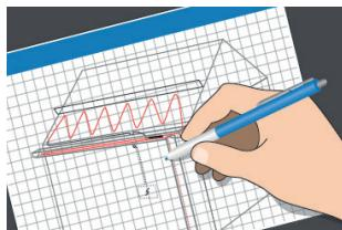
2. Разработете плана за разположение на кабелите, сензорите и терморегулаторите, кабелните съединения/студените краища, разклонителната кутия, кабелните канали и разпределителното табло.
