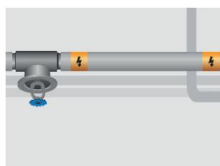
9. Etter isolering plasseres merketape på isolasjonskappen eller rørgatene for hver 5 m. I installasjoner under bakken skal det legges et dekkbånd med advarselsskjilt 10 cm over kablene.
