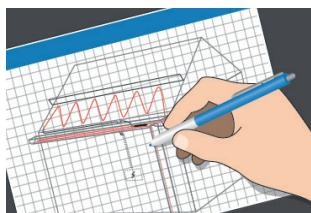
2. Desenăți planul de așezare pentru cabluri, senzori și termostate, conexiuni de cabluri/cabluri reci, cutia de legături, trasee de cabluri și un panou de comandă.
