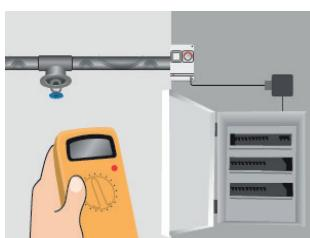
8. Ponownie sprawdzić oporność izolacji. Połączyć kable do puszki połączeniowej i do tablicy rozdzielczej.
