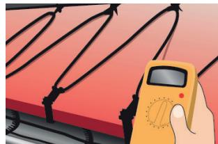
6. Montieren Sie die Leitung(en) auf dem Dach, in Ablaufrinnensystemen und Fallröhren. Prüfen Sie die Installation erneut und gleichen Sie den Isolationswiderstand ab.
