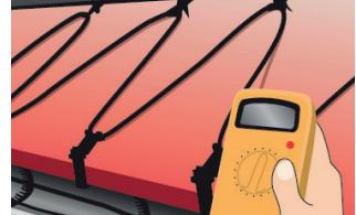
6. Nainstalujte kabely na střechu, do žlabů a dešťových svodů. Znovu zkontrolujte a porovnejte izolační odpor.
