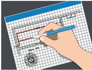
2. Nacrtajte plan s položajem kabela, osjetnika i termostata, kabelskim spojevima, hladnim krajevima, spojnom kutijom, putanjama kabela i razvodnom pločom.
