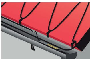
7. Telepítse az érzékelőket, hosszabbítsa meg az érzékelők kábeleit és a hidegvégeket/zárja le a kábelek végét, és száraz környezetbe helyezze a csatlakozásokat. Tömtsen minden áthatolási helyet (pl. tető, falon keresztül).
