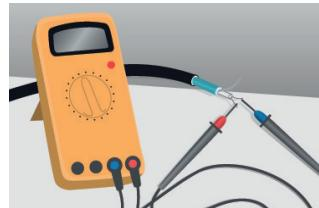
3. Kontrollera värmekablarnas isoleringsmotstånd. Det uppmätta värdet ska vara minst 50 MΩ.
