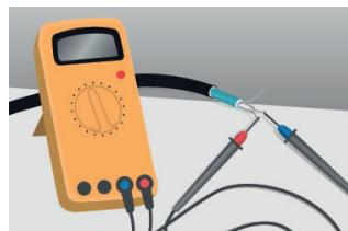
3. Compruebe la resistencia de aislamiento de los cables calefactores. El valor medido no debe ser inferior a  $50\text{ M}\Omega$ .
