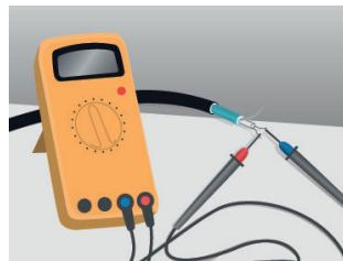
3. Проверьте сопротивление изоляции нагревательных кабелей. Измеренное значение должно быть не менее 50 МОм.
