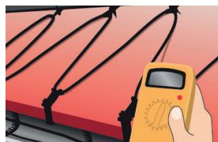
6. Instale o(s) cabo(s) no telhado, em caleiras e tubos descendentes. Verifique novamente e compare a resistência de isolamento.
