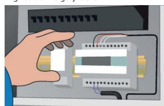
9. Installeer de thermostaat/regelaar en sluit de kabels aan op de aansluitdozen en op het schakelpaneel.
