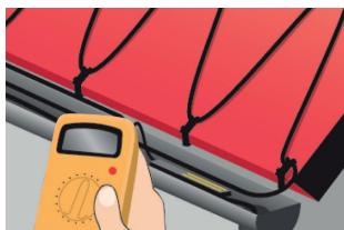
6. Установите кабель (кабели) на крыше, в водосточных желобах и водосточных трубах. Снова проверьте и сравните сопротивление изоляции.
