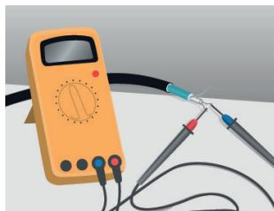
3. Skontrolujte izolačný odpor vykurovacích kálov. Jeho nameraná hodnota nesmie byť menšia ako  $50\text{ M}\Omega$ .
