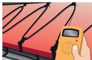
5. Asenna kytkeytäreasia ja kiinnitystarvikkeet räystäkouruihin ja vesikouruihin katolle ja/ tai kaapeliin.
