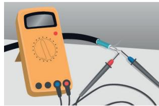
3. 检查加热电缆的绝缘阻值。测得的值应不小于 50 MΩ。
