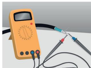
3. Compruebe la resistencia de aislamiento de los cables calefactores. El valor medido no debe ser inferior a  $50\text{ M}\Omega$ .
