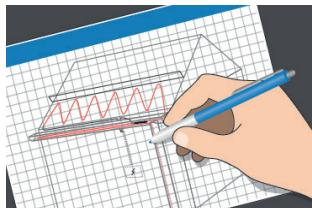
2. Lag en layoutplan for kabelen/kablene, følere og termostater, kabelkoblinger, kaldender, koblingsboks, kabelbaner og brytertavle.
