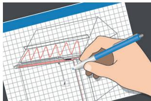
2. Izstrādājiet izkārtojuma plānu kabeliem, sensoru termostatam, kabelu savienojumiem, atdzesētajiem galiem, savienotājkārbai, kabeļu kanāliem un sadales dēliem.
