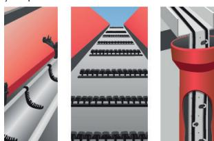
5. Instalați cutia de legături și accesorile de fixare în jgheaburi, în adânciturile jgheaburilor, pe acoperiș și/sau pe cablu.
