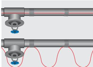
5. Suorat kaapelijohdot ja anturi on asennettava kuvan 2 osoittamalla tavalla. Mutkalle taiututut kaapelijohdot kiinnitetään putkeen kuvan mukaisesti noin metrin välein alumiinitiepilla.
