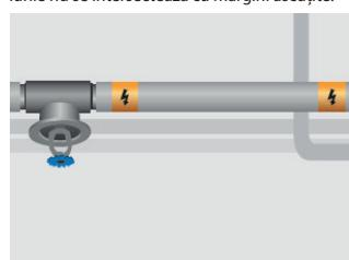
9. După izolare, plasați benzile cu marcaje de siguranță pe mantaua de izolare sau pe șanțurile conductei la fiecare 5 m. În cazul instalațiilor în subteran, la 10 cm deasupra cablurilor trebuie așezată o panglică cu un indicator de avertizare.
