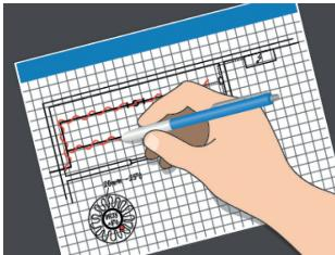
2. Nakreslete si plánek s rozmístěním kabelů, čidel a termostatu, a s umístěním spojení kabelů, studeného vedení, spojovací krabičce, vedení kabelů a rozvaděče.
