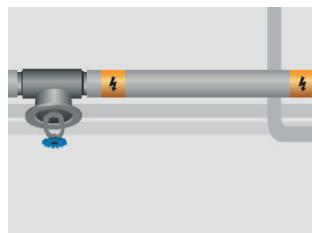
7. Monter og tildæk føleren og den øverste del af røret med aluminiumstape. Forlæng koldkabler/ledninger, og hold tilslutningerne tørre. Monter tilslutningsboksen på røret eller tæt på det, og installer termostaten på røret eller i nærheden af det (afhænger af termostaten).
