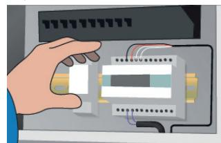
7. Установите датчики и удлините кабели датчиков, холодные концы / выводные кабели и разместите соединения в сухих местах. Загерметизируйте все сквозные отверстия, например, в крышах и стенах.
