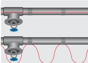
5. Raka ledningar och givare ska monteras enligt bild 2. Lindade kablar fästs med aluminiumtejp på det sätt som visas, med cirka en meters mellanrum.
