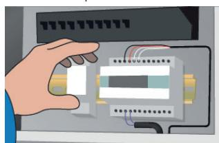
7. Vérifiez à nouveau et comparez la résistance d'isolation. La valeur mesurée ne doit pas être inférieure à 50 MΩ.
