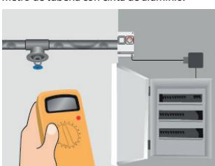
8. Vuelva a comprobar la resistencia de aislamiento. Conecte los cables a las cajas de conexión y al panel de control.
