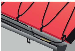
7. Установіть датчики й видовжте іхні кабелі, холодні кінці / вивідні кабелі й укладіть з'єднання насухо. Загерметизуйте всі місця проходження, наприклад крізь дахи та стіни.
