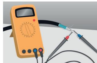
3. Preverite izolacijsko upornost grelnih kablov. Izmerjena vrednost ne sme biti nižja od  $50\text{ M}\Omega$ .
