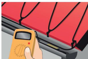
8. Ще раз перевірте її і порівняйте опір ізоляції. Вимірюване значення має бути не меншим за  $50\text{ M}\Omega$ .
