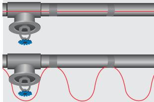
5. Rechte leidingen en de sensor moeten worden aangebracht zoals getoond in fig. 2. Gevluchte draden worden voor ongeveer elke meter leiding bevestigd met aluminium tape, zie de afbeelding.
