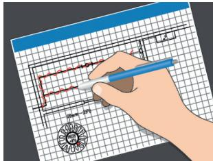
2. Desenhe um plano de posicionamento dos cabos, dos sensores e do termostato, das ligações de cabos, do terminal de fio, da caixa de ligações, dos caminhos dos cabos e do quadro elétrico.
