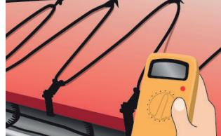
6. 在屋顶上、檐沟和落水管中安装电缆。再次检查并比较绝缘阻值。
