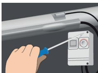
7. Připevněte a zakryjte čidlo a hrot na horní straně trubky hliníkovou páskou. Prodlužte koncovky studeného vedení a udržujte spojení v suchu. Na trubku nebo do její blízkosti namontujte spojovací krabičky a nainstalujte termostat na trubku nebo do její blízkosti (podle daného termostatu).
