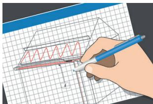
2. Élaborez le plan de disposition des câble(s), sondes et thermostats, raccordements de câble/liens froids, boîtier de raccordement, chemins de câble et tableau de distribution.
