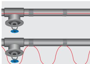
5. Linie proste i czujnik należy zamontować w sposób przedstawiony na rys. 2. Linie skręcone należy przymocować tak, jak pokazano co około 1 m rury za pomocą taśmy aluminiowej.
