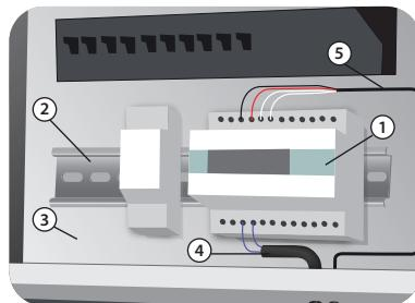
1 – Regler; 2 – DIN-Schiene; 3 – Schaltschrank; 4 – Kaltleiteranschluss; 5 – Fühleranschluss
