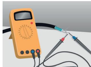
3. Kontrollera värmekablarnas isoleringsmotstånd. Det uppmätta värdet ska vara minst 50 MΩ.
