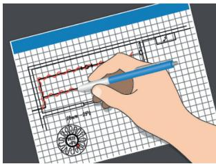
2. Narišite načrt položajev kablov, tipala, termostatov, kabelskih priključkov, hladnega voda, priključne omarice, kabelskih napeljav in stikalne plošče.
