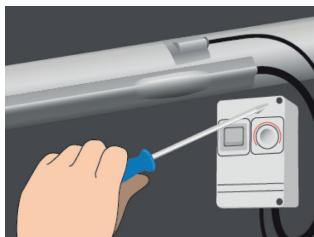
7. Befestigen Sie den Fühler und decken Sie diesen sowie die Spitze an der Oberseite des Rohrs mit Aluminiumband ab. Verlängern Sie unbediente Enden/Kälteleiter und halten Sie die Anschlüsse trocken. Montieren Sie die Anschlussdose an oder neben dem Rohr und installieren Sie das Thermostat an oder neben dem Rohr (in Abhängigkeit vom Thermostat).
