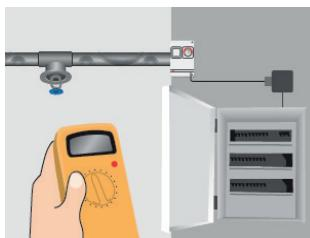
8. Verifique novamente a resistência de isolamento. Ligue os cabos às caixas de ligações e ao quadro elétrico.
