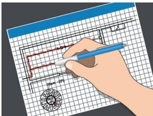
2. Намалюйте план розташування кабелів, датчиків і терморегулятора, кабельних з'єднань, холодного кінця, з'єднувальної коробки, кабельних трас і комутаційної панелі.
