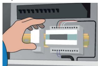
9. Asenna termostaatti/säädin ja kytkeytäkaapelit kytkeytäreasioihin ja kytkeytätaulun.
