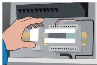
8. Vuelva a comprobarlo y compare la resistencia de aislamiento. El valor medido no debe ser inferior a  $50\text{ M}\Omega$ .
