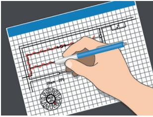
2. Zeichnen Sie einen Positionsplan für Kabel, Fühler und Thermostate, Kabelanschlüsse, Kälteleiter, Anschlussdose, Kabelwege und Schalttafel.
