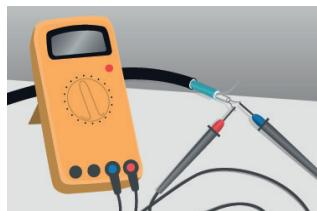
3. Vérifiez la résistance d'isolation des câbles chauffants. La valeur mesurée ne doit pas être inférieure à 50 MΩ.
