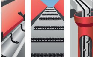
5. Installera kopplingsdosan och fästanordningar i hängrännor, ränndalar, på taket och/eller vid kabeln.
