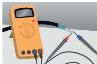
3. Перевірте опір ізоляції нагрівальних кабелів. Вимірюване значення має бути не меншим за  $50\text{ M}\Omega$ .
