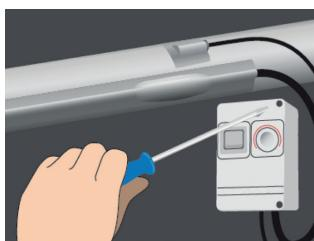
7. Fäst och täck givaren och spetsen på röret med aluminiumtejp. Förläng kalkkablarna och håll anslutningarna torra. Montera kopplingsboxen på röret eller i närlheten av det och installera termostaten på röret eller i närlheten av det (beroende på termostat).
