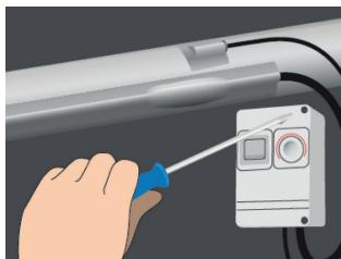
7. Fixe e cubra o sensor e a ponta no topo do tubo com fita de alumínio. Expanda os terminais/condutores de frio e mantenha-as como ligações secas. Monte a caixa de ligações no tubo, ou junto a ele, e instale o termostato no tubo ou junto a ele (depende do termostato).
