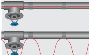
5. As linhas retas e o sensor têm de ser instalados conforme ilustrado na Fig. 2. As linhas torcidas são instaladas conforme mostrado para cada tubo de aprox. 1 m com fita de alumínio.
