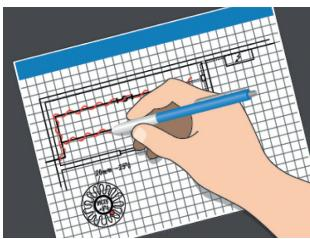
2. Vypracujte si plán rozmiestnenia kálov, snímačov a termostatu, kálových pripojení, studených koncoviek, rozvodnej skrine, kálových trás a rozvádzacza.
