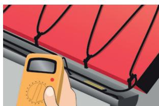
8. Še enkrat preverite in primerjajte izolacijsko upornost. Izmerjena vrednost ne sme biti nižja od  $50\text{ M}\Omega$ .
