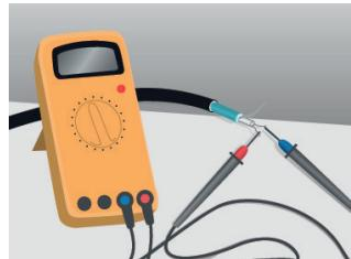
3. Zkontrolujte izolační odpor topných kabelů. Naměřená hodnota nesmí být nižší než 50 MΩ.
