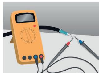
3. Sprawdzić oporność izolacji kabli grzejnych. Zmierzona wartość nie może być mniejsza niż 50 MΩ.
