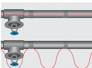
5. Прямі лінії та датчик мають бути розташовані так, як показано на рис. 2. Виті лінії прикріплюються до труби за допомогою алюмінієвої стрічки з інтервалом приблизно в 1 м, як показано на рисунку.
