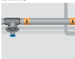
9. Po ukončení izolácie umiestnite bezpečnostnú znáčkovaciu pásku každých 5 m na izolačný plášť alebo do rýh pre potrubia. Pri podpovrchových inštaláciách musí byť 10 cm nad káblami položená krycia páska s výstražným štítkom.
