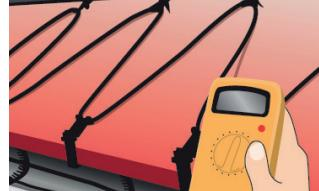
6. Installera kablarna på taket, i hängrännor och stuprör. Kontrollera ännu en gång isoleringsmotståndet.
