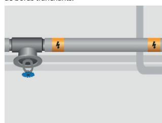
9. Après l'isolation, placez du ruban adhésif de marquage de sécurité sur la gaine d'isolation ou les tranchées de tube tous les 5 m. Dans les installations souterraines, un ruban de protection avec un panneau d'avertissement doit être placé à 10 cm au-dessus des câbles.
