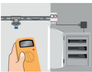
8. Kontrollera isoleringsmotståndet igen. Anslut kablarna till kopplingsdosor och till reglercentralen.
