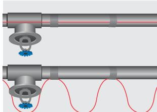
5. Cablurile drepte și senzorul trebuie să fie montate așa cum se arată în Fig. 2. Cablurile răsucite sunt fixate pe conductă cu bandă de aluminiu după cum se arată, la fiecare aprox. 1 m.
