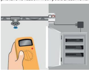
8. Znovu skontrolujte izolačný odpor. Pripojte káble k rozvodným skriniam a k rozvádzacza.
