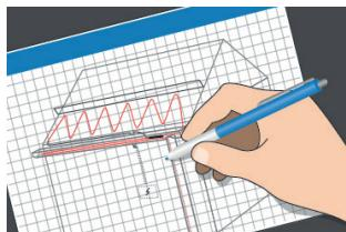
2. Opracować plan rozmieszczenia kabli, czujników i termostato, połączeń kablowych/przewodów doprowadzających, puszek połączeniowych, kanałów kablowych i tablicy rozdzielczej.
