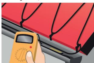
6. Installez les sondes et étendez les câbles de sonde, les câbles d'extrémité/liens froids et placez les raccordements à sec. Scellez toutes les pénétrations, par exemple à travers les toits et les murs.
