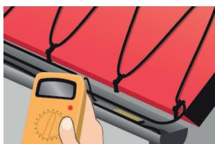
8. Kontrollera ännu en gång isoleringsmotståndet. Det uppmätta värdet ska vara minst 50 MΩ.
