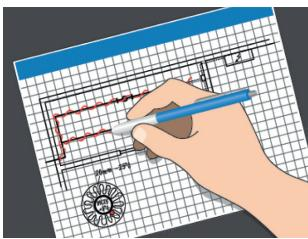
2. Dibuje un esquema de colocación de los cables, los sensores y el termostato, las conexiones de cable, el extremo frío, la caja de conexión, el recorrido de los cables y el panel de control.
