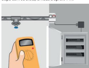
8. Verificați din nou rezistența izolației. Conectați cablurile la tablourile de legături și la panoul de comandă.
