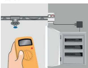
8. Kontroller isolasjonsmotstanden på nytt. Koble kablene til koblingsboksen og til brytertavle.
