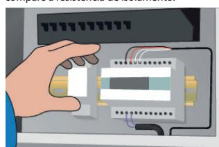
9. Instale o termostato/controlador e ligue os cabos às caixas de ligação e ao quadro elétrico.
