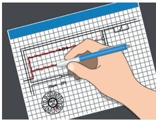
2. Dessinez un plan de positionnement des câble(s), sondes et thermostat, raccordements de câble, liaison froide, boîtier de raccordement, chemins de câble et tableau de distribution.
