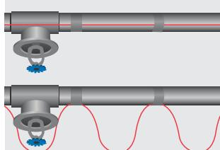
5. Прямые линии и датчик должны быть установлены, как показано на рис. 2. Витые линии прикрепляют с помощью алюминиевой ленты, как показано на рисунке, через каждый приблизительно 1 м трубы.
