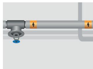
9. След изолацията поставете защитна маркираща лента върху изолационния кожух или тръбните канали на всеки 5 m. При подземните инсталации на 10 cm над кабелите трябва да се постави покриващо фолио с предупредителен знак.
