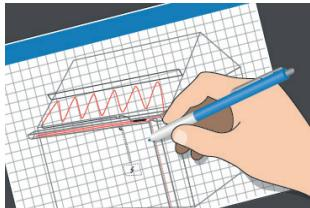
2. Ta fram en ritning för placering av kablar, givare och termostat, kabelanslutningar, kallkabel, kopplingsdosa, kabelvägar och instrumenttavlå.
