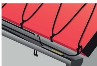
7. Instale os sensores e estenda os cabos do sensor, terminais de frio/cabos terminais e estabeleça ligações secas. Vede todas as penetrações, por exemplo, através de telhados e paredes.
