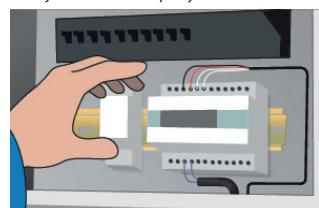
9. Installer termostater/regulatorer, og koble kablene til koblingsboksene og bryterpanelet.
