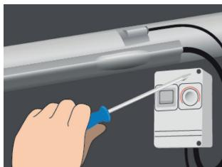
7. Закрепите датчик и наконечник на верхней части трубы и закройте их алюминиевой лентой. Удлините холодные концы/выходы и держите соединения в сухом состоянии. Закрепите соединительную коробку на трубе или рядом с ней и установите терmostат на трубу или рядом с ней (в зависимости от типа термостата).
