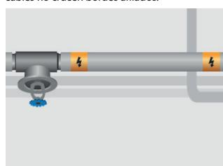
9. Tras el aislamiento, coloque cinta de marcado de seguridad en la camisa de aislamiento o en las zanjas de las tuberías cada 5 m. Para instalaciones subsuperficie, debe colocarse una cinta de cubierta con una señal de advertencia 10 cm por encima de los cables.
