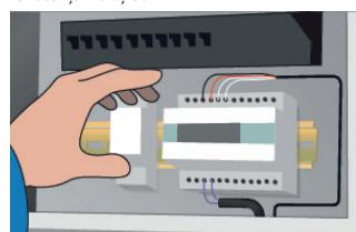
9. Instalați termostatul/regulatorul și conectați cablurile la cutiile de legături și la panoul de comandă.
