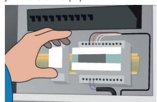
9. Termostati/kontrol cihazını takın ve kablolari bağlantı kutularına ve dağıtım panosuna bağlayın.
