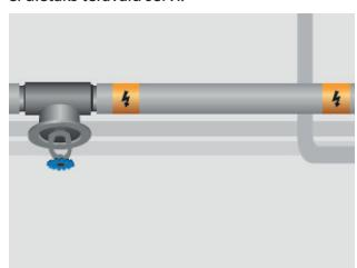
9. Pärast isoldeerimist tuleb isolatsioonistakale või torusüvendistesse paigaldada iga 5 m järel märgistusteip. Pinnasealustele paigaldiste korral tuleb kaabiltest 10 cm jagu kõrgemale asetada hoiatussildiga kattelint.
