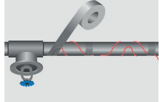
6. Breng aluminium tape onder (verplicht voor kunststof leidingen) en boven de volledige lengte van de kabel aan. Voorkom dat de kabels scherpe randen kruisen.
