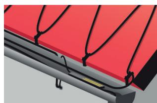
7. Sensörleri takın ve sensör kablolari uzatın, soğuk kuyrukları/kabloları sonlandırmak ve bağlantıları kuru olarak yerleştirin. Çatılar ve duvarlar gibi tüm penetrasyonları sızdırmaz hale getirin.
