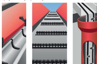
5. Instalirajte spojnu kutiju i opremu za pričvršćivanje u oluke, krovne uvale, na krov i/ili kabel.
