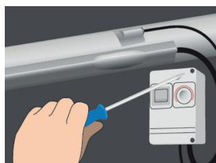
7. Aluminijskom trakom pričvrstite i prekrijte osjetnik i vŕšak iznad cijevi. Produljite hladne krajeve/vodove i održavajte spojeve suhim. Montirajte spojnu kutiju na cijev ili blizu nje i instalirajte termostat na cijev ili blizu nje (ovisno o termostatu).
