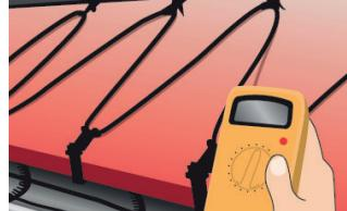
6. Розташуйте кабелі на даху, у жолобах і водостічних трубах. Ще раз перевірте її порівняйте опір ізоляції.
