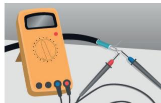
3. Skontrolujte izolačný odpor vykurovacích káblow. Jeho nameraná hodnota nesmie byť menšia ako  $50\text{ M}\Omega$ .
