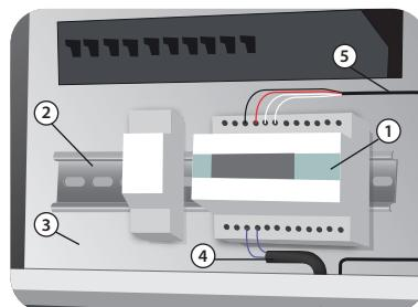
1 – Regulator; 2 – řină DIN; 3 – Dulap electric; 4 – Conexiune la cablul rece; 5 – Conexiune senzor
