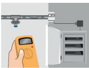
8. Znova preverite izolacijsko upornost. Kable priključite na priključne omarice in stikalno ploščo.
