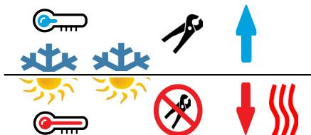
Den varme delen av kabelen må ikke installeres i vegg eller rør.
