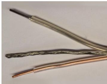
1. a. Avisoler 50 mm i enden av tilledningen.
