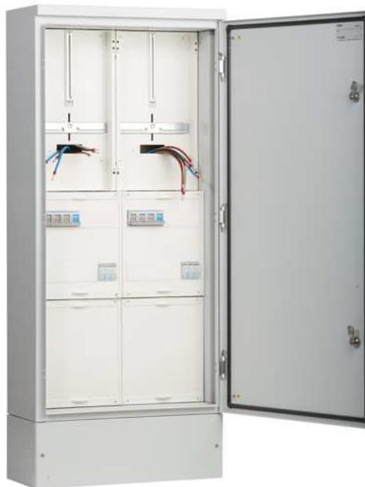
Dobbelt målerskap 400V TN, TSFT72TN-elnr 2400322 sokkel FZ642W (ikke inkl)
